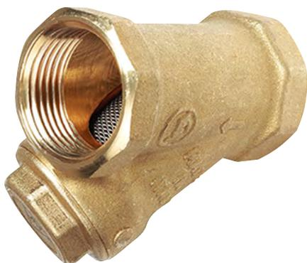
R74M è un filtro magnetico a Y, ispezionabile, idoneo per la distribuzione di fluidi non pericolosi (gruppo 2 secondo direttiva PED) e non aggressivi per leghe di rame. Il filtro con rete metallica e magnete nasce per evitare che le impurità solide entrino nelle tubazioni e, depositando, riducano le sezioni di passaggio aumentando le perdite di carico ed i fenomeni di ossidazione.
