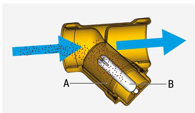
Il flusso termovettore entra nel filtro e subisce un rallentamento tale da favorire la separazione delle impurità solide.
